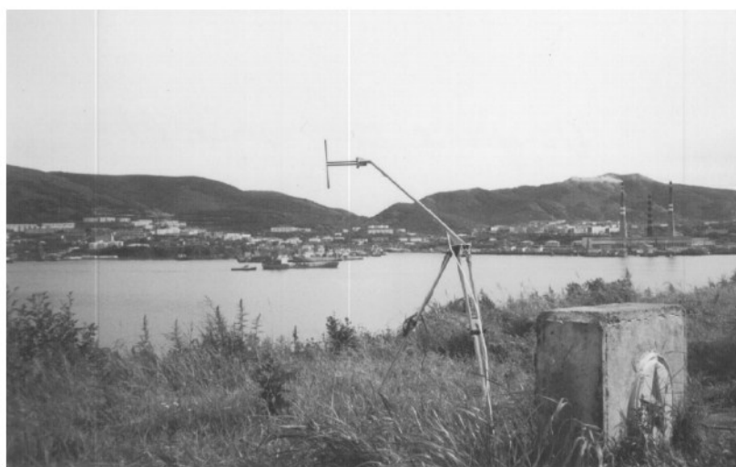
Рис. 4. Проектирование антенны над центром маркшейдерского пункта
